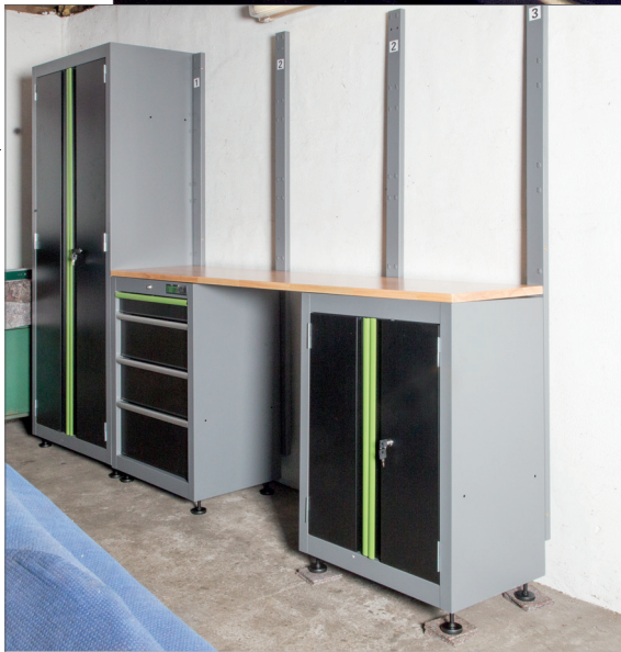
Die Basis steht. Jetzt werden Lochtafeln und Oberschränke einfach an den senkrechten Streben aufgehängt
